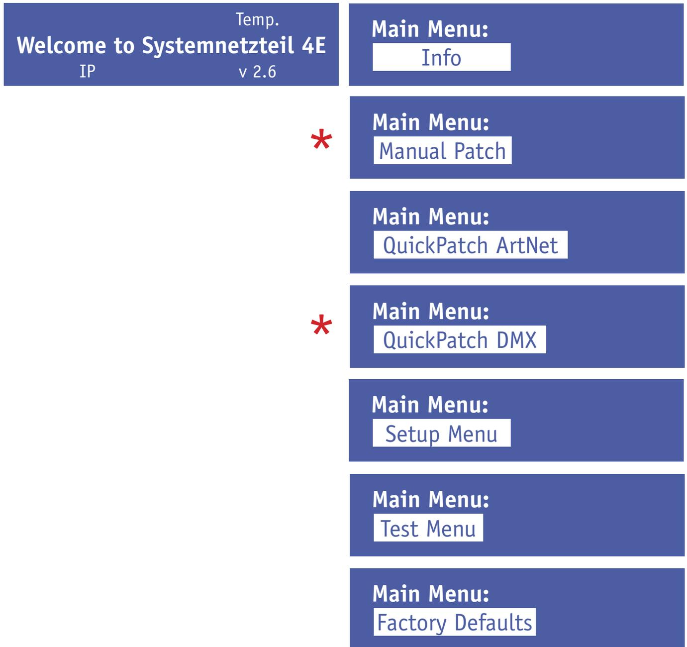
\* Output Typ S3-DMX: Manual Patch und QuickPatch DMX entfallen
